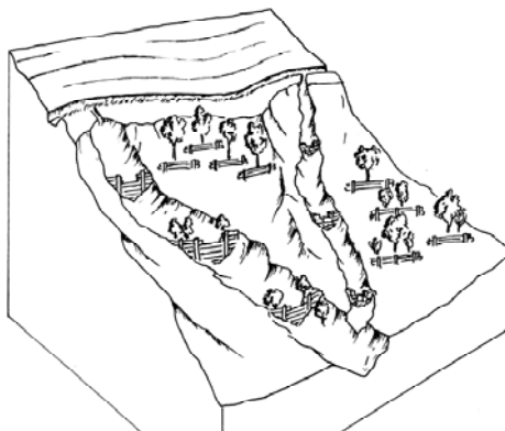
Control de cárcavas y protección de la cuenca con medidas integradas tales como drenajes de corte, represas de madera o de piedra y estructuras escalonadas para plantación de árboles. Cochabamba, Bolivia. (Dibujo: Mats Gurtner)
